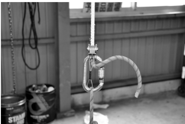
加重後 (ロープ被覆破損)
